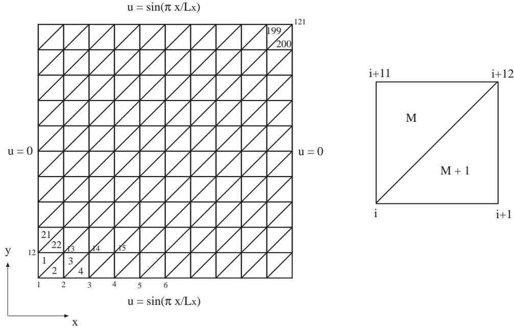
Figura 1: Malla de elementos finitos y esquema de numeración de nodos y elementos.
