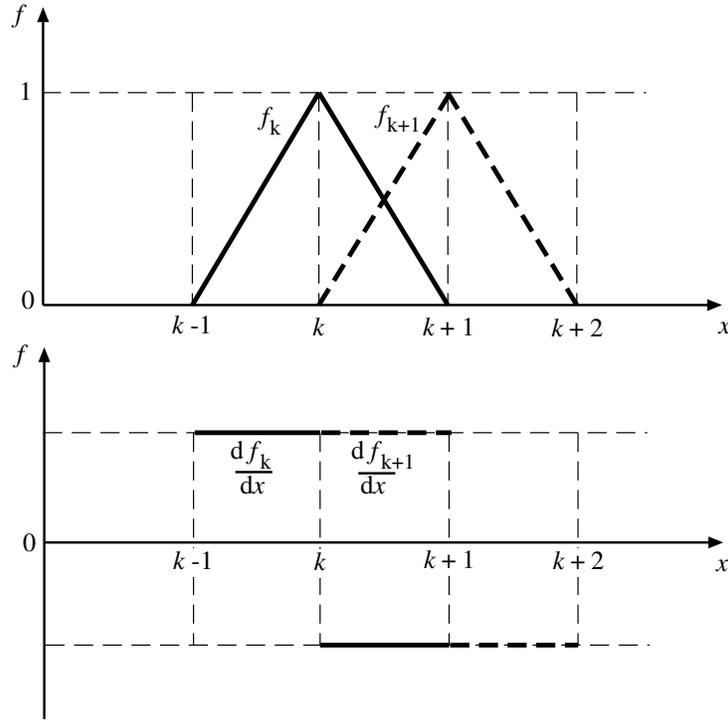
Figura 1: Funciones base lineales y sus derivadas.
