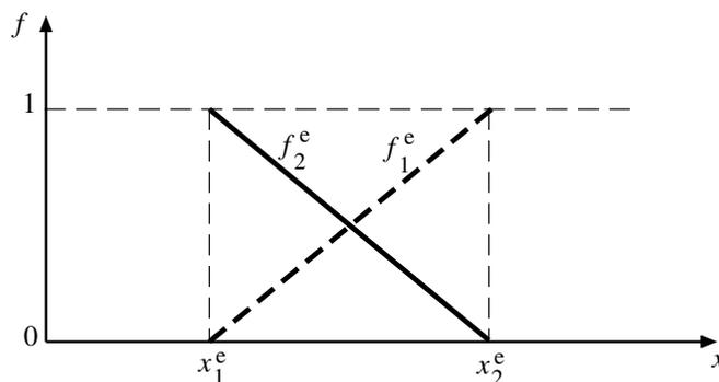
Figura 2: Funciones base en el elemento.
