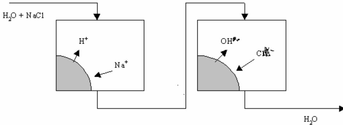
La regeneración se hace mediante una solución de  $H_2SO_4$  para la resina de intercambio catiónico (sale sulfato de sodio) y de soda cáustica ( $NaOH$ ) para la aniónica (sale  $NaCl$ ).
