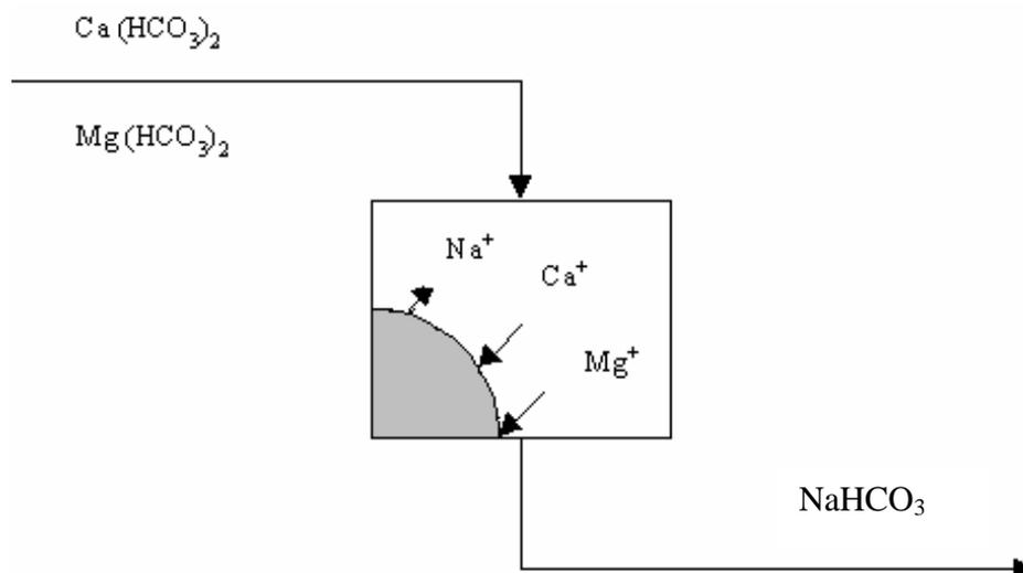
La regeneración se hace mediante una solución concentrada de NaCl que invierte el proceso. Al haber una gran concentración de iones de sodio la resina libera el calcio y el magnesio y los reemplaza por iones de sodio.
