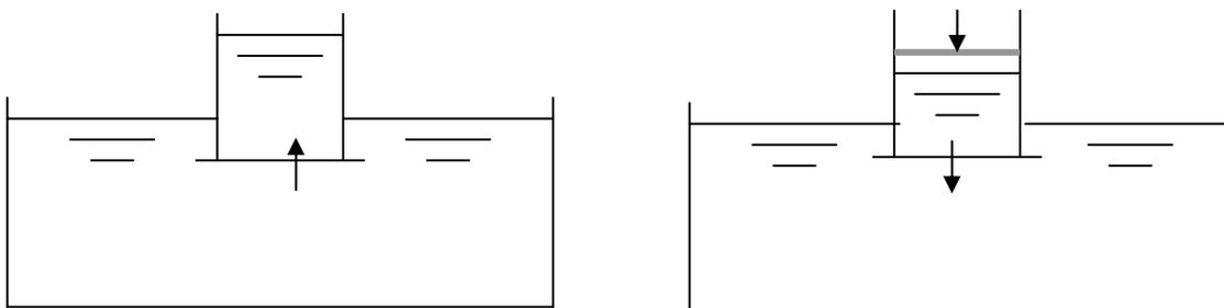
**Presión osmótica:** En la primera figura, si en el recipiente superior, separado del inferior por una membrana semipermeable, hay una mayor concentración de sales, el agua pasará hacia arriba, produciendo un incremento de la cota y una diferencia de presión a ambos lados de la membrana. La diferencia de presión que produce un estado de equilibrio se denomina presión osmótica y es mayor cuanto mayor es la diferencia de concentración de sales.
