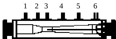
Figura 6.2. Tubo de Venturi.
