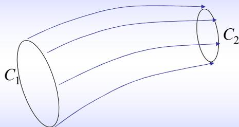
Un vector velocidad no puede salir perpendicular a la superficie definida por el manto del tubo de flujo.
