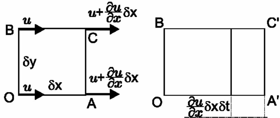
El elemento se deformará si la velocidad de **OB** es distinta que la velocidad de **AC**.
