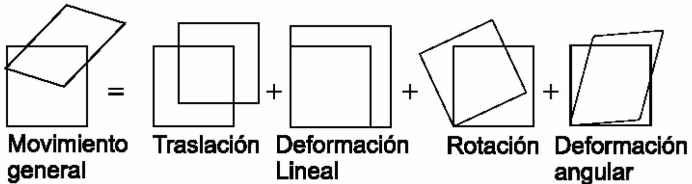
➔ Variaciones de las distintas componentes de la velocidad ( $u, v, w$ ) en todas las direcciones ➔  $(\partial V_i / \partial x_j) \neq 0 \forall i, j$
