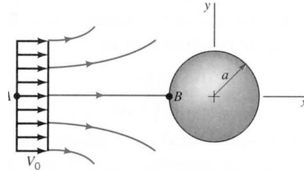
El campo de velocidades sobre la línea de corriente  $\mathbf{AB}$  viene dado por  $\mathbf{V} = V_0(1+a^3/x^3) \hat{i}$ , donde  $V_0$  es la velocidad aguas arriba y “lejos” de la esfera. Determinar la aceleración de una partícula que se mueve por  $\mathbf{AB}$ .
