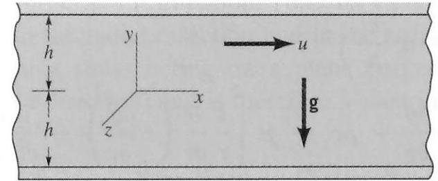
Determinar el campo de velocidades que se establece para el flujo permanente e incompresible entre dos placas paralelas e infinitas donde la placa inferior esta fija y la superior se mueve con una velocidad constante  $U$ . Este tipo de flujo se denomina Flujo de Couette.
