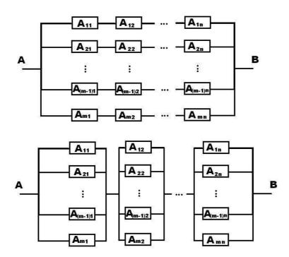
Las componentes  $A_{jk}$  tienen una probabilidad p de funcionar ( (1-p) de fallar) y lo hacen en forma independiente. Calcule para ambos circuitos la probabilidad que exista flujo desde el punto A hasta el punto B.
