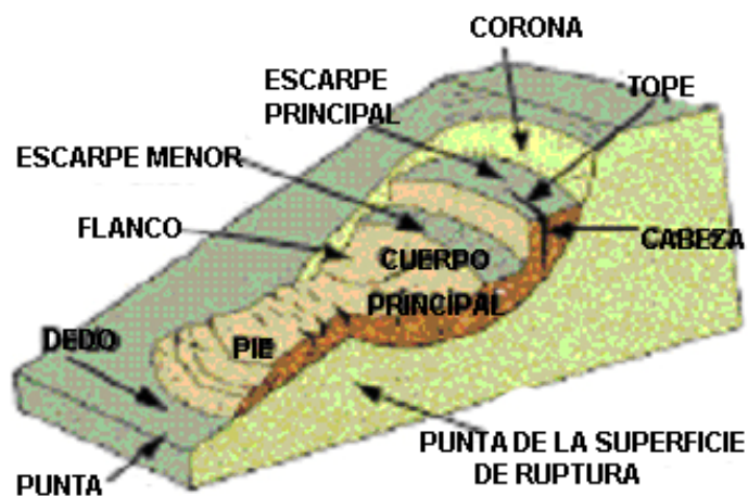
Figura A1.2. Partes de un deslizamiento (Varnes, 1978).
