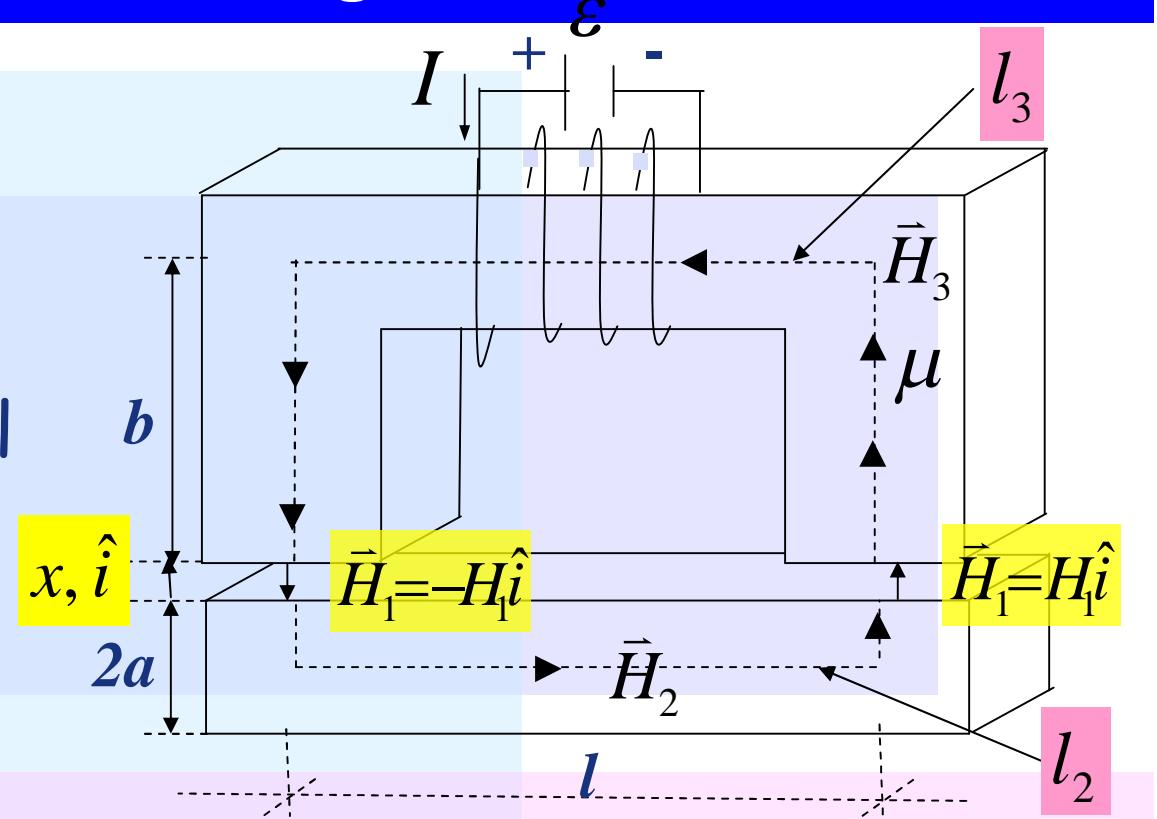
$$\oint \vec{H} \cdot d\vec{l} = \int_{l_3} \vec{H}_1 \cdot dx \hat{i} + \int_{l_3} \vec{H}_3 \cdot d\vec{l} + \int (-H_1) \cdot dx (-\hat{i}) + \int_{l_2} \vec{H}_2 \cdot d\vec{l}$$
