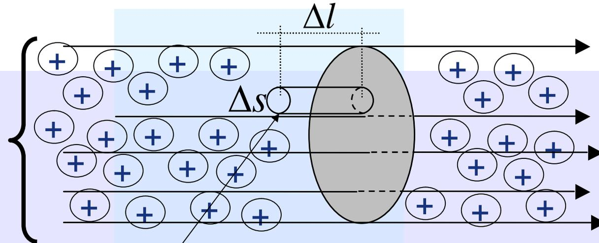
Volumen del cilindro  $\Delta v = \Delta s \times \Delta l$
