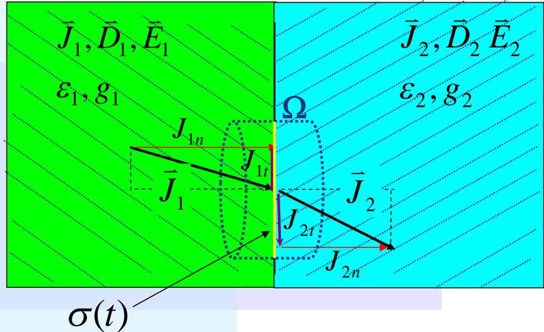
Haciendo tender la altura del cilindro a cero  $\frac{\partial Q}{\partial t}$  se acumula sólo en la superficie que limita los medios
