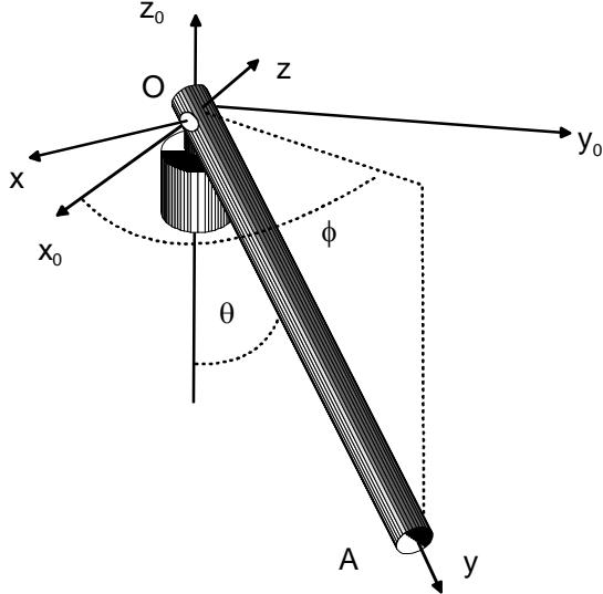
La barra  $OA$  indicada en la figura está unida a un dispositivo en  $O$  que le permite cambiar libremente los ángulos de inclinación respecto a la vertical  $z_0$  y el ángulo  $\phi$  de su proyección sobre el plano horizontal  $x_0y_0$ . Los ejes  $Oxyz$  son ejes principales de inercia en  $O$ ,  $y$  a lo largo de la barra,  $xy$  perpendiculares a la barra en  $A$  y el eje  $x$  horizontal.
