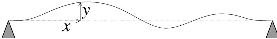
La cuerda es levemente extensible y se puede deformar verticalmente (se dice que se deforma transversalmente a la dirección en la que está estirada).
