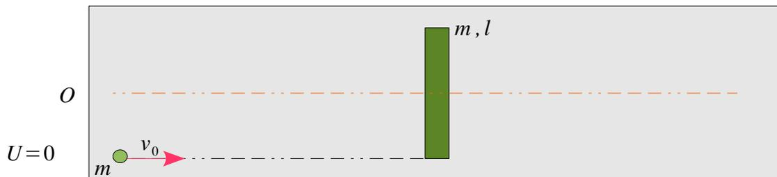
El proyectil queda incrustado en la barra y esta comienza a trasladarse con una velocidad  $V_f$  hacia la derecha, sin embargo se observa una rotación en torno a su nuevo centro de masa, encuentre la velocidad angular  $\omega$  con que girará la barra en nuestra aproximación.
