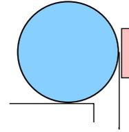
14. Una ardilla de masa  $m$  corre aceleradamente dentro de un cilindro hueco de radio  $R$  y masa  $M$ . La ardilla en ningún momento resbala y el cilindro posa sobre un plano rugoso horizontal. A consecuencia de su movimiento acelerado la ardilla se mantiene siempre a una altura  $h$  del suelo. Determine la aceleración con que se traslada el cilindro. hfa[ $\gamma$ ]
