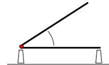
6. Un lápiz de masa uniforme es sostenido desde un extremo por una cuerda mientras su otro extremo posa sobre una superficie rugosa ( $\underline{\mu}$ ). El lápiz forma un ángulo  $\underline{\theta}$  con el piso y se encuentra a punto de resbalar. Determine los ángulos posibles entre la cuerda y el lápiz. Determine la tensión en cada caso. Analice el caso  $\underline{\mu} = 0$  e interprete.
