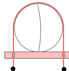
3. En la figura se muestra un cilindro de masa  $\underline{M}$  y radio  $\underline{R}$  el cual se ata horizontalmente a la muralla mediante una cuerda. Un calado se ha hecho sobre el cilindro y se enrolla una cuerda ideal de la cual pende una carga de masa  $m$  por determinar. Si el coeficiente de roce entre el suelo y el cilindro es  $\underline{\mu}$ , determine la masa máxima a colgar para que el cilindro no rote.
