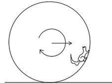
15. Una rueda de masa  $M$ , radio  $R$  y momento de inercia con respecto a su eje  $I$  es lanzada horizontalmente sin rotar sobre una superficie rugosa. La rueda entra a un tramo horizontal rugoso con rapidez  $v_o$ , cuyo coeficiente de roce mutuo es  $\mu$ . Determine la longitud del tramo de resbalamiento de la rueda. hfa[ $\beta$ ]
