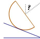
11. Uno de los extremos de una cadena de masa  $\underline{M}$  se clava en el punto más alto de una cúpula semiesférica lisa de radio  $\underline{R}$ . La longitud de la cadena es  $\pi R/2$ . Determine la tensión de la cadena en función del ángulo  $\theta$  indicado. hfa[ $\beta\gamma$ ]
