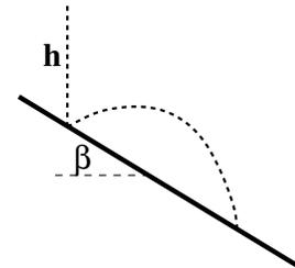
7. Una bolita desliza sin fricción sobre un plano inclinado en un ángulo  $\beta$  con respecto a la horizontal. La bolita es soltada desde una altura  $H$  con respecto al piso y rebota elásticamente con el piso. Determine la altura máxima del rebote y el lapso desde el comienzo de la caída hasta tocar el piso por segunda vez. hfa[ $\beta$ ]
