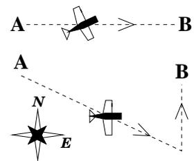
4. Un avión vuela de sur a norte un trayecto de 1000 km de longitud. En ausencia de vientos el avión tarda 4 h en recorrer el trayecto. En el momento del viaje hay vientos de 30 km/h hacia el sur-oeste. Determine el mínimo retraso del avión en el viaje.
