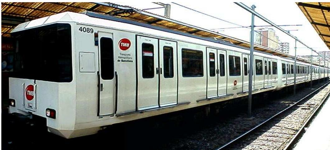
Figura N°1: tren de corriente continua a 1500 V utilizado en el metro de Barcelona.
