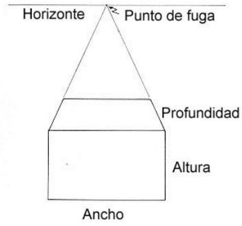
Figura 10.11: Un cubo dibujado con un punto de perspectiva.
