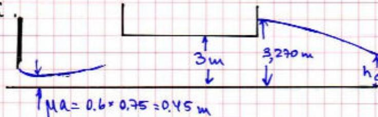
Aguas abajo de la compuerta puede desarrollarse un torrente, el que ensamblará con el río de aguas abajo mediante un resalto, el que podría ubicarse entre la compuerta y el acueducto, dentro del acueducto (resalto en presión) o entre el acueducto y el cambio de pendiente.
