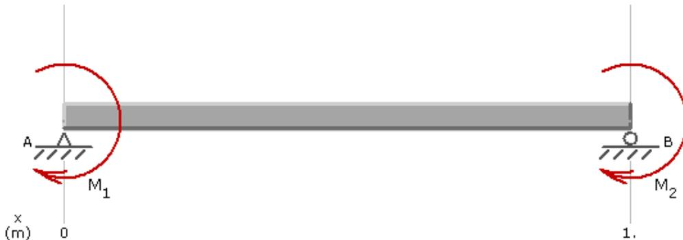
**Fig N°3:** Esquema Viga de Longitud  $L$ ,  $M_1=2M_0$  y  $M_2=M_0$ ,
