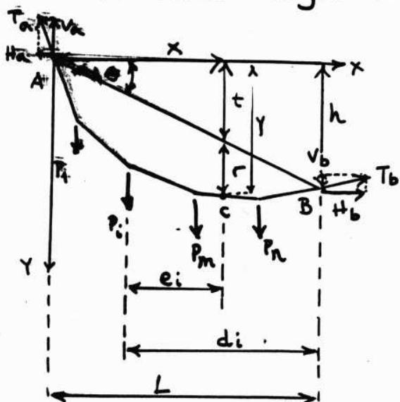
Puesto que los cables sólo transmiten tracciones, las reacciones  $T_a$  y  $T_b$  son tangenciales a los apoyos respectivos.
