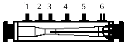
Figura 6.2. Tubo de Venturi.
