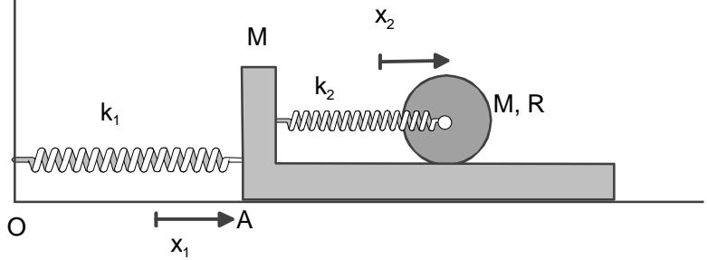
$$\omega = \frac{\dot{x}_2}{R}, \quad v_G = \dot{x}_1 + \dot{x}_2, \quad I_G = \frac{1}{2}MR^2,$$
