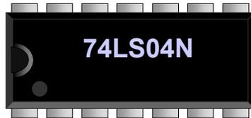
Este circuito es un negador. De hecho tiene seis negadores dentro: el símbolo de un negador (“NOT”) es precisamente el triángulo con un pequeño círculo en la punta.
