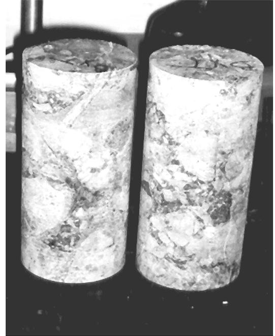
Figura 11 : Probetas de 100 mm de diámetro y 200 mm de altura de la Brecha Braden de mina El Teniente en Chile.
