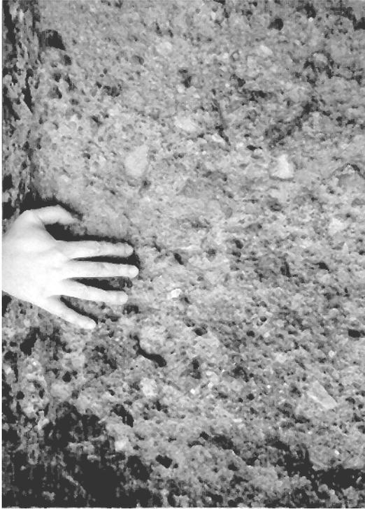
Figura 10 : Brecha Braden de la mina El Teniente en Chile. Esta roca es una brecha cementada que prácticamente no tiene discontinuidades. Se trató en forma similar a un concreto débil y se ejecutaron ensayos sobre probetas de 100 mm de diámetro, las que se muestran en Figura 11.
