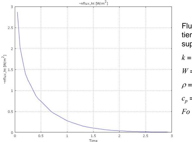
Flujo de calor en el tiempo a través de superficie en x=0
