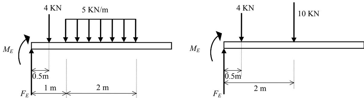
$$\left. \begin{aligned} F_E &= 14 \text{ kN} \\ M_E &= -4 \cdot 0,5 - 10 \cdot 2 = -22 \text{ kN} \cdot \text{m} \end{aligned} \right\} \text{Reacciones que ejerce el empotramiento sobre la viga.}$$
