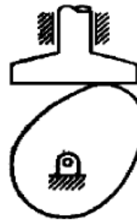
Seguidor Traslacional de Cara Plana
