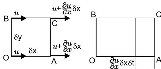
Figura 3.3: Deformación lineal de una partícula fluida.
