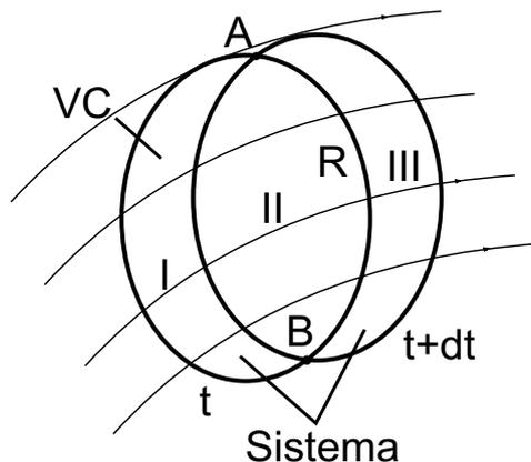
Figura 3.5: Volumen de Control y Sistema en  $t$  y  $t + dt$ .
