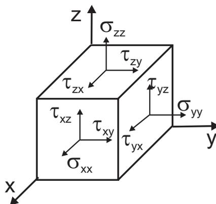
Figura 7.1: Esfuerzos sobre un elemento de fluido.
