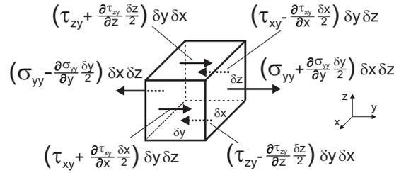
Figura 7.2: Balance de fuerzas sobre un elemento de fluido.
