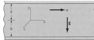
Determinar el campo de velocidades que se establece para el flujo permanente e incompresible entre dos placas paralelas e infinitas donde la placa inferior esta fija y la superior se mueve con una velocidad constante  $U$ . Este tipo de flujo se denomina Flujo de Couette.
