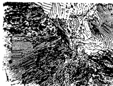
Figura 10.8. Microestructura de un acero eutectoide enfriado lentamente. La microestructura consta de perlita eutectoide laminar. La fase oscura, atacada con ácido, es cementita y la fase blanca ferrita. (Ataque: picro; ampliación \times 650 ). (United States Steel Corp., tal como aparece en «Metals Handbook», vol. 8, 8.ª ed., American Society for Metals, 1973, pág. 188.)
