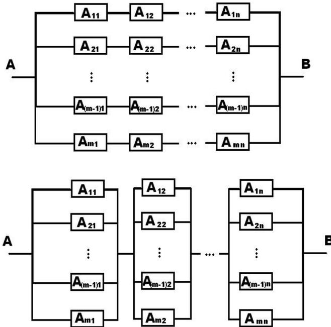
Las componentes  $A_{ij}$  tienen una probabilidad  $p$  de funcionar ( $(1-p)$  de fallar) y lo hacen en forma independiente. Calcule para ambos circuitos la probabilidad que exista flujo desde el punto A hasta el punto B.
