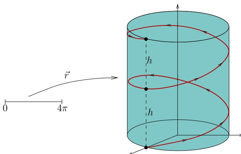
Podemos pensar que la hélice es una trayectoria que sigue el contorno de un cilindro dado (en este caso de radio  $a$  y altura  $2h$ ).
