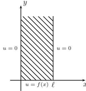
Figura 14.3: Dominio semi-infinito para la ecuación de Laplace
