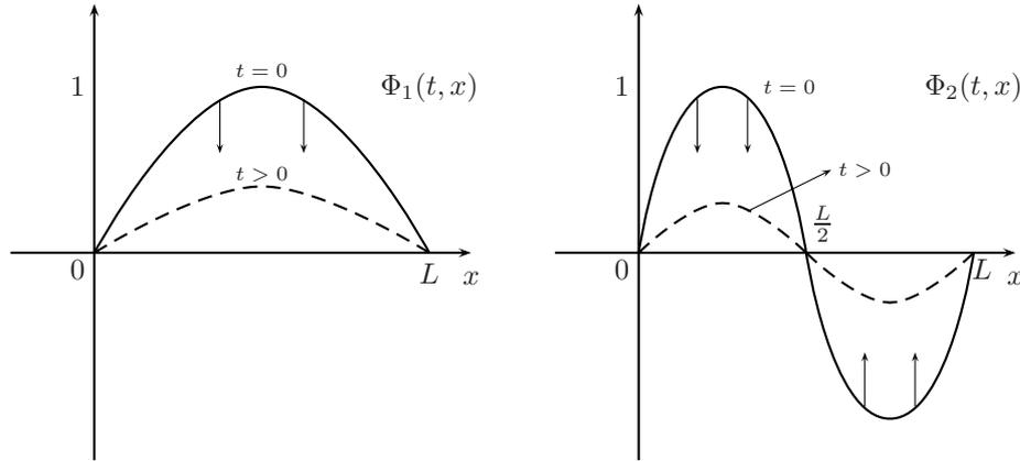
Figura 14.1: Dos soluciones fundamentales de la ecuación del calor
