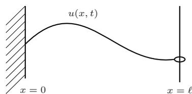
Figura 14.4: Cuerda de largo  $\ell$  con un extremo fijo y el otro libre
