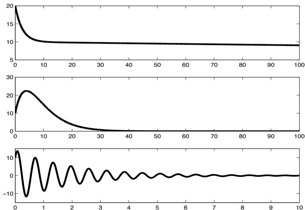
FIGURA 2. Regimen Sobreamortiguado (arriba), Críticamente Amortiguado (centro) y Subamortiguado (abajo), con  $C_1 = C_2 = 10$ .
