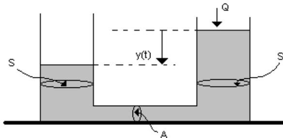
4. (C1-2001-1-Osses) *Represa*. Motivados por los movimientos de un líquido que ocurren en la chimenea de una represa al cerrar una válvula (ver figura), estudiaremos el modelo simplificado del movimiento de un líquido incompresible en un tubo en U (ver Fig.2).
