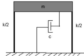
Haciendo un diagrama de cuerpo libre de la viga y utilizando la ecuación de equilibrio dinámico, se obtiene que la ecuación diferencial que rige el movimiento horizontal de la viga es:
