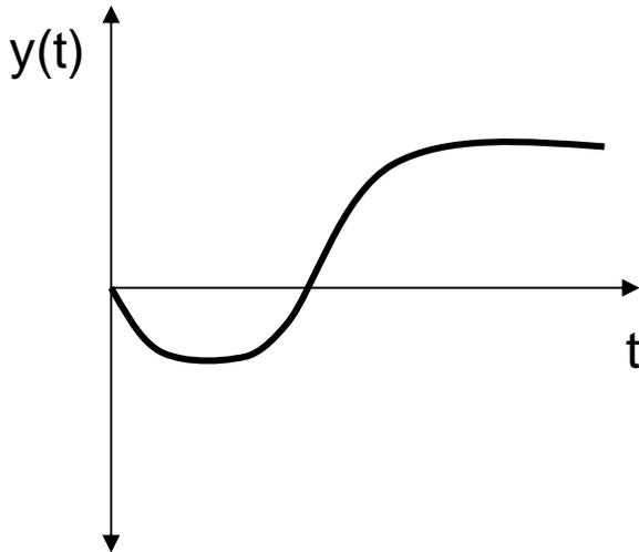
Un sistema tendrá respuesta inversa si su función de transferencia tiene un cero con parte real positiva.
