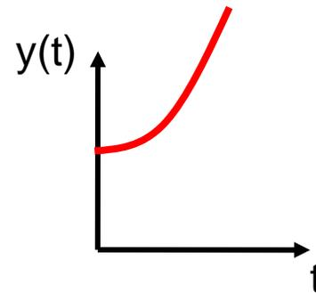
El signo del polo determina si la respuesta crece infinitamente o si decae a cero.
