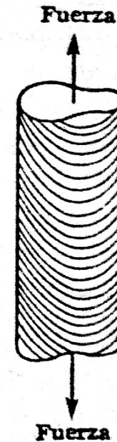
FIG. 4.2. Líneas de deslizamiento sobre el cristal de magnesio
