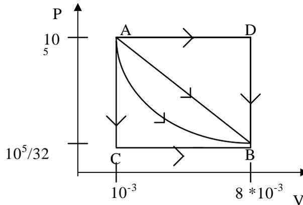
En el proceso ADB el gas es calentado a presión constante ( $P_2=10^5$  Pa) desde un volumen inicial  $V_1 = 10^{-3} \text{ m}^3$  hasta su valor final de  $V_2 = 8 \cdot 10^{-3} \text{ m}^3$ . El gas es entonces enfriado a volumen constante hasta que su presión decrece:  $P_1 = 10^5/32$  Pa. El otro proceso (ACB y AB) puede ser similarmente interpretado, de acuerdo a la figura.
