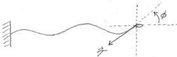
La figura de arriba muestra un DCL del anillo sin masa. Aplicando la 2<sup>a</sup> ley de Newton:
