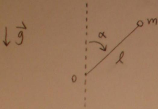
La masa  $m$  tiene 2 restricciones, debe estar en el plano de la hoja y a una distancia fija  $l$  del punto  $O$ . Luego hay un solo grado de libertad ( $3-2=1$ ) y la coordenada generalizada que usaremos es  $\alpha$ .
