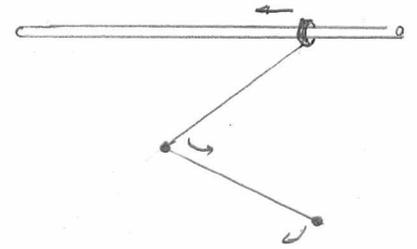
Modo 3: Los dos péndulos oscilan a una misma frecuencia  $2\sqrt{\frac{g}{l}}$ , en direcciones opuestas. El centro de masa solo se mueve verticalmente.
