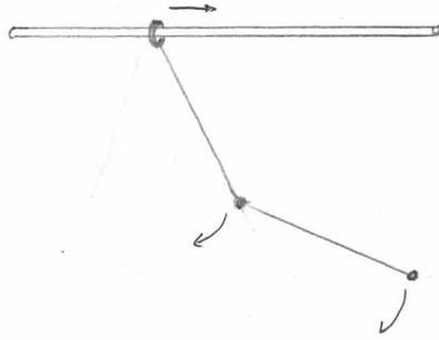
Modo 2: Los dos péndulos oscilan en una misma dirección a la vez, a misma frecuencia  $\sqrt{\frac{g}{l}}$ . El centro de masa del sistema solo se mueve verticalmente.
