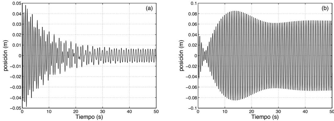
Figura 3: Ejemplos de soluciones  $x(t)$  obtenidas con  $M = 0,778$  kg,  $\tau = 4,72$  s,  $k = 78$  N/m,  $F_o = 0,25$  N,  $x(0) = 0,05$  m,  $\dot{x}(0) = 0$ . En (a),  $\omega = 7$  rad/s y en (b)  $\omega = 9,8$  rad/s. La frecuencia natural de resonancia es  $\omega_o = \sqrt{k/M} = 10$  rad/s.
