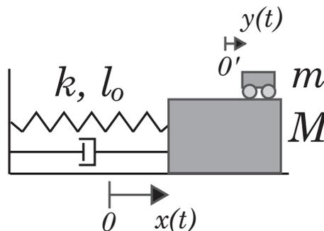
Figura 5: Esquema de un oscilador amortiguado compuesto por un resorte, una masa y algún tipo de roce. El forzaje externo sobre la masa  $M$  se obtiene por un movimiento oscilatorio impuesto a la masa  $m$ , es decir con  $y(t) = y_o \sin(\omega t)$ .
