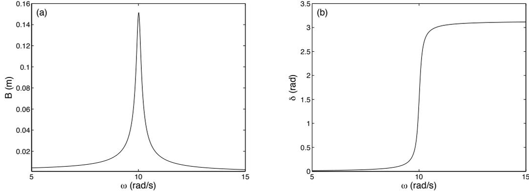
Figura 4: (a) Curva de resonancia de la amplitud  $B$  como función de  $\omega$ . (b) Diferencia de fase  $\delta$  como función de  $\omega$ . Ambas curvas fueron obtenidas con  $M = 0,778 \text{ kg}$ ,  $\tau = 4,72 \text{ s}$ ,  $k = 78 \text{ N/m}$ ,  $F_o = 0,25 \text{ N}$ . La frecuencia natural de resonancia es  $\omega_o = \sqrt{k/M} = 10 \text{ rad/s}$ .
