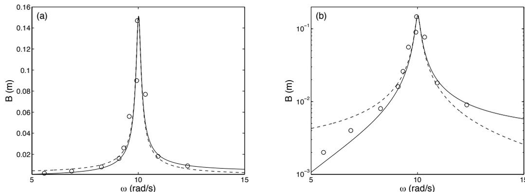
Figura 6: Curvas de resonancias de la amplitud  $B$  como función de  $\omega$ , en escala lineal (a) y en escala semilogarítmica (b). La curva segmentada es la misma presentada en la figura 4a. La curva continúa se obtuvo con la ecuación (16) con  $M = 0,735$  kg,  $m = 43$  g,  $y_o = 5,8$  cm,  $\tau = 4,72$  s,  $k = 78$  N/m,  $\omega_o = \sqrt{k/(M + m)} = 10$  rad/s. Los datos (o) corresponden a medidas experimentales.
