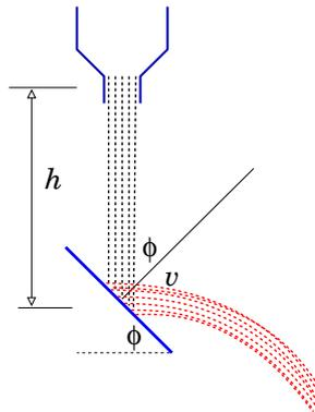
Una manera de constatar la proporcionalidad con  $v^2$  es midiendo la fuerza sobre la superficie inclinada y analizar su comportamiento con la altura de caída de granos que caen desde un embudo. Por conservación de energía tenemos que  $v^2 = 2gh$ , con  $g$  la aceleración de gravedad y  $h$  la distancia entre el punto de impacto de los granos y el embudo. Así,
