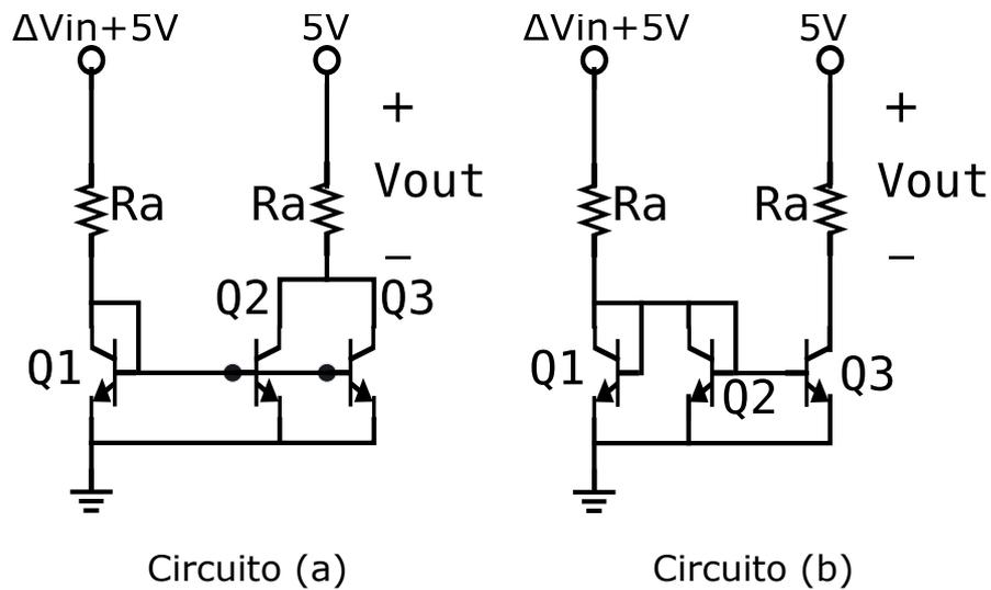
El circuito se polariza con 5V. La resistencia  $R_a$  es de 1K.  $\Delta V_{in}$  es una señal pequeña, que varía en el rango de  $\pm 5mV$ .
