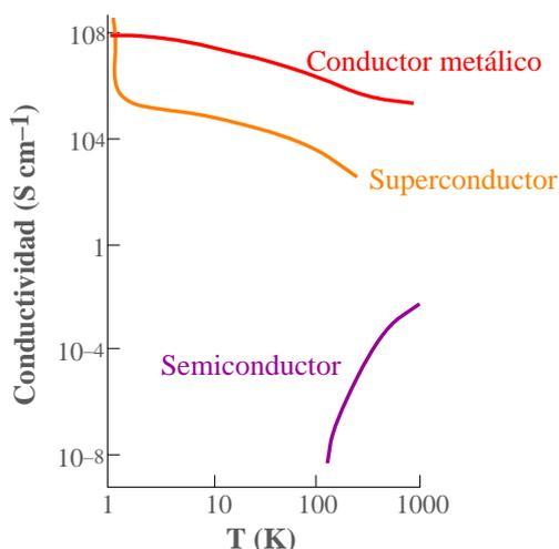
**Figura 4.12.** La conductividad de un **semiconductor** aumenta fuertemente con la temperatura, mientras que la de un **conductor metálico** disminuye.
