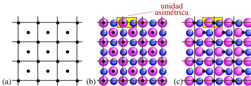
**Figura 4.3.** (a) Representación de los puntos de la red del NaCl, cuya estructura se muestra en (b) o (c). Cada punto representa la localización de una unidad asimétrica  $\text{Na}^+\text{Cl}^-$ . La situación del punto en la unidad asimétrica es arbitrario. En (b) se ha puesto en el ion  $\text{Cl}^-$ ; en (c) en un punto intermedio entre los iones  $\text{Na}^+$  y  $\text{Cl}^-$ , con igual resultado.
