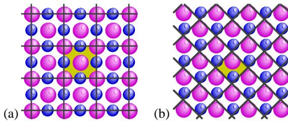
**Figura 4.2.** Un sólido de dos dimensiones y dos opciones de celdilla unidad. Cualquiera de las dos reproduce el cristal completo, pero se prefiere generalmente la opción (a) ya que muestra la máxima simetría de la estructura, contrariamente a (b).
