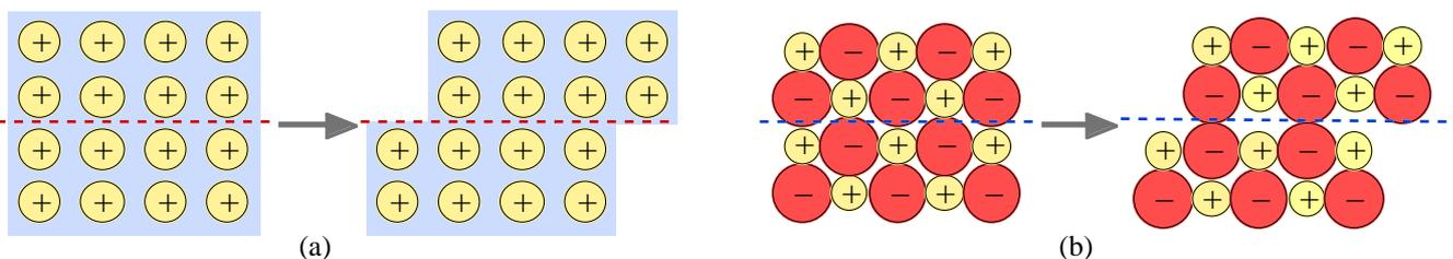
**Figura 4.14.** (a) El desplazamiento del cristal metálico según un plano no produce grandes fuerzas de repulsión. (b) El desplazamiento de un cristal iónico según un plano produce intensas fuerzas de repulsión y distorsión del cristal.
