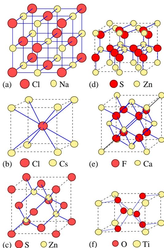
**Figura 4.16.** (a) La estructura tipo cloruro de sodio puede verse como un empaquetamiento cúbico compacto de voluminosos aniones  $\text{Cl}^-$ , en el que los cationes  $\text{Na}^+$  ocupan los  $N$  agujeros octaédricos. Cada ion está rodeado de 6 contraiones (iones de carga opuesta). En una celdilla unidad hay 4 iones  $\text{Na}^+$  y 4 iones  $\text{Cl}^-$  (tener en cuenta que un ion de un vértice se comparte entre 8 celdillas unidad, uno de un lado entre 4 y uno de una cara entre 2).
