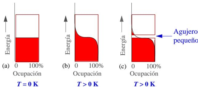
**Figura 4.11.** (a) A  $T = 0 \text{ K}$ , los electrones ocupan los orbitales de las bandas por orden de energía. (b) A  $T > 0 \text{ K}$ , la agitación térmica de los electrones hace que algunos de ellos puedan ocupar niveles de energía mayores. (c) Un semiconductor, a  $T = 0 \text{ K}$ , tiene una banda llena y otra vacía con un agujero de energía relativamente pequeño. A  $T > 0 \text{ K}$ , algunos electrones saltan de la banda llena a la vacía, posibilitando la conducción.
