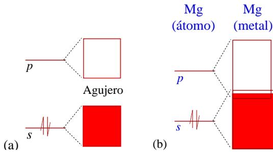
**Figura 4.9.** (a) El agujero entre las bandas  $s$  y  $p$  de un sólido depende de la separación de energía entre los orbitales  $s$  y  $p$  y de la fortaleza de la interacción entre los átomos (las bandas son más anchas cuando la interacción es fuerte). (b) A veces, las bandas pueden superponerse. Este es el caso de metales como el magnesio, lo que justifica su conductividad eléctrica.
