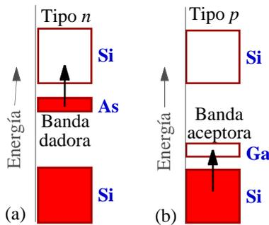
**Figura 4.13.** (a) Al dopar un cristal de silicio con átomos de As, hay un electrón adicional por cada átomo dopante. Estos electrones adicionales están en una banda localizada en los átomos de As, que es muy estrecha si los átomos de As están muy alejados unos de otros. A  $T > 0$ , algunos de los electrones del As saltan a la banda vacía del Si, es decir a un átomo vecino de Si, migrando de silicio en silicio a través de la red cristalina.
