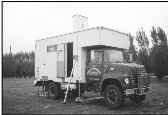
Camión para ensayo CPTU de la University of British Columbia (UBC)
