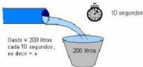
Aforar es medir un caudal. Para realizar un aforo en un sistema hidráulico, se puede **medir directamente** el volumen, en un recipiente y el tiempo, con un cronómetro.
