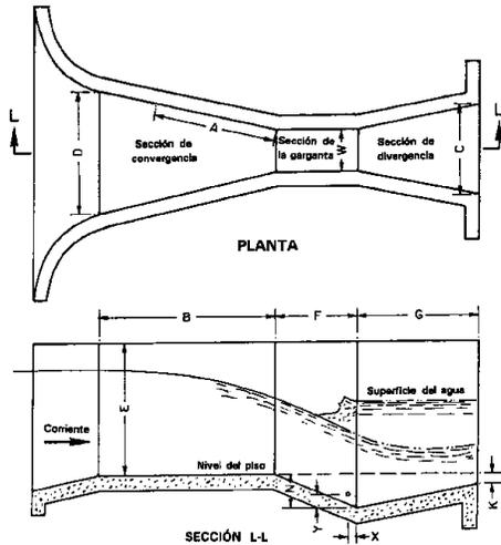
La sección control del medidor está situada cerca del final de la sección convergente.
