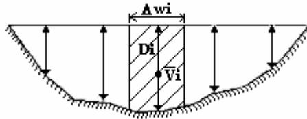
Por su parte, la velocidad  $V_i$ , en un punto, se puede medir, por ejemplo, con alguno de los siguientes dispositivos: flotador y reloj, molinetes y sensores de inducción magnética.
