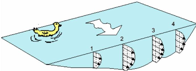
Un molinete mide la velocidad en un único punto, es por esto que, para calcular el caudal total se deben realizar varias mediciones.
