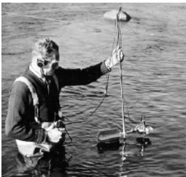
Los molinetes pueden ir montados en soportes o suspendidos de cables. Antes de ser usados en el campo, deben ser calibrados por el fabricante para determinar la relación entre la velocidad de rotación de la hélice y la velocidad del agua.
