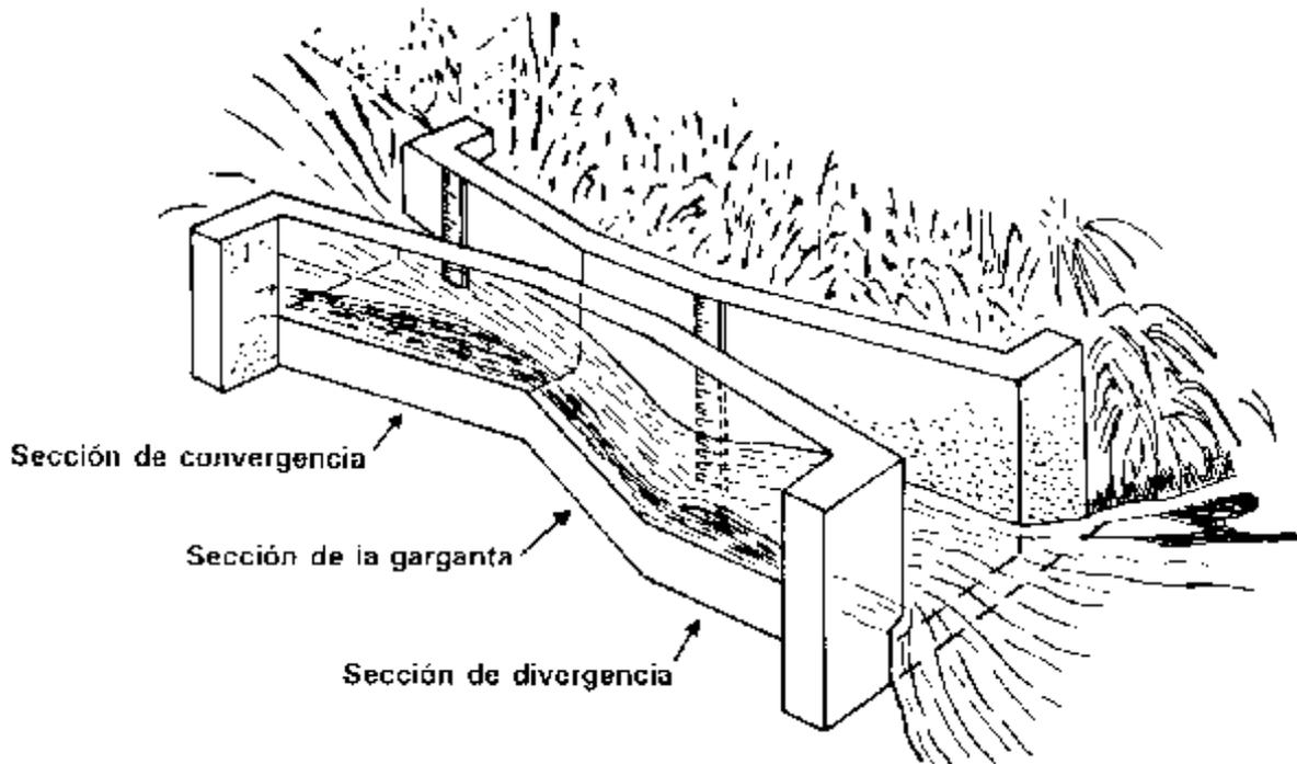
(1) La canaleta opera con una condición no sumergida o de flujo libre. Si el factor  $H_b/H_a$  excede el límite de 0,6 para canaletas de 3, 6 y 9 pulg., el flujo se vuelve sumergido. El efecto de la sumergencia es de reducir el caudal, por lo tanto si se presenta este fenómeno, se debe corregir por un factor  $\geq 1$ . (Hidráulica de Canales Abiertos, Ven Te Chow).
