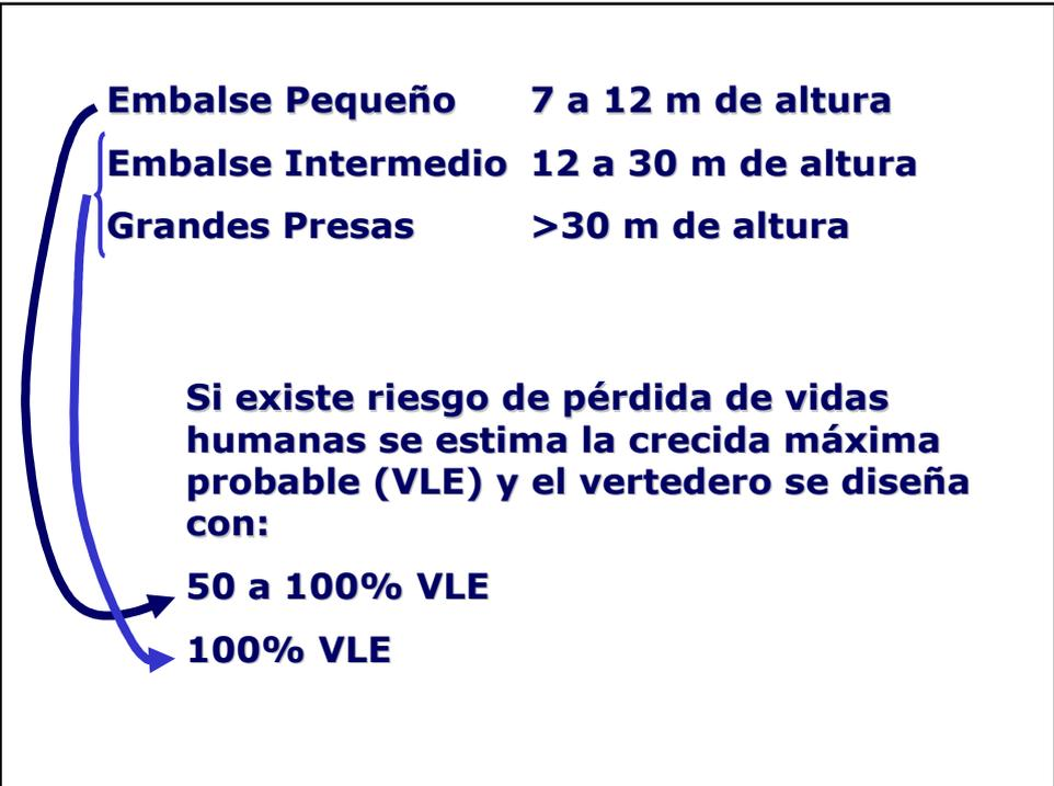
**Riesgo: estructura falla si Caudal de diseño se excede al menos 1 vez, durante la vida útil de la obra.**
