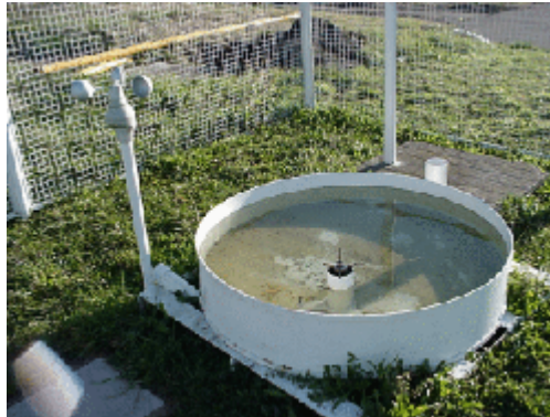
Fig. 1.4: Tanque de Evaporación
