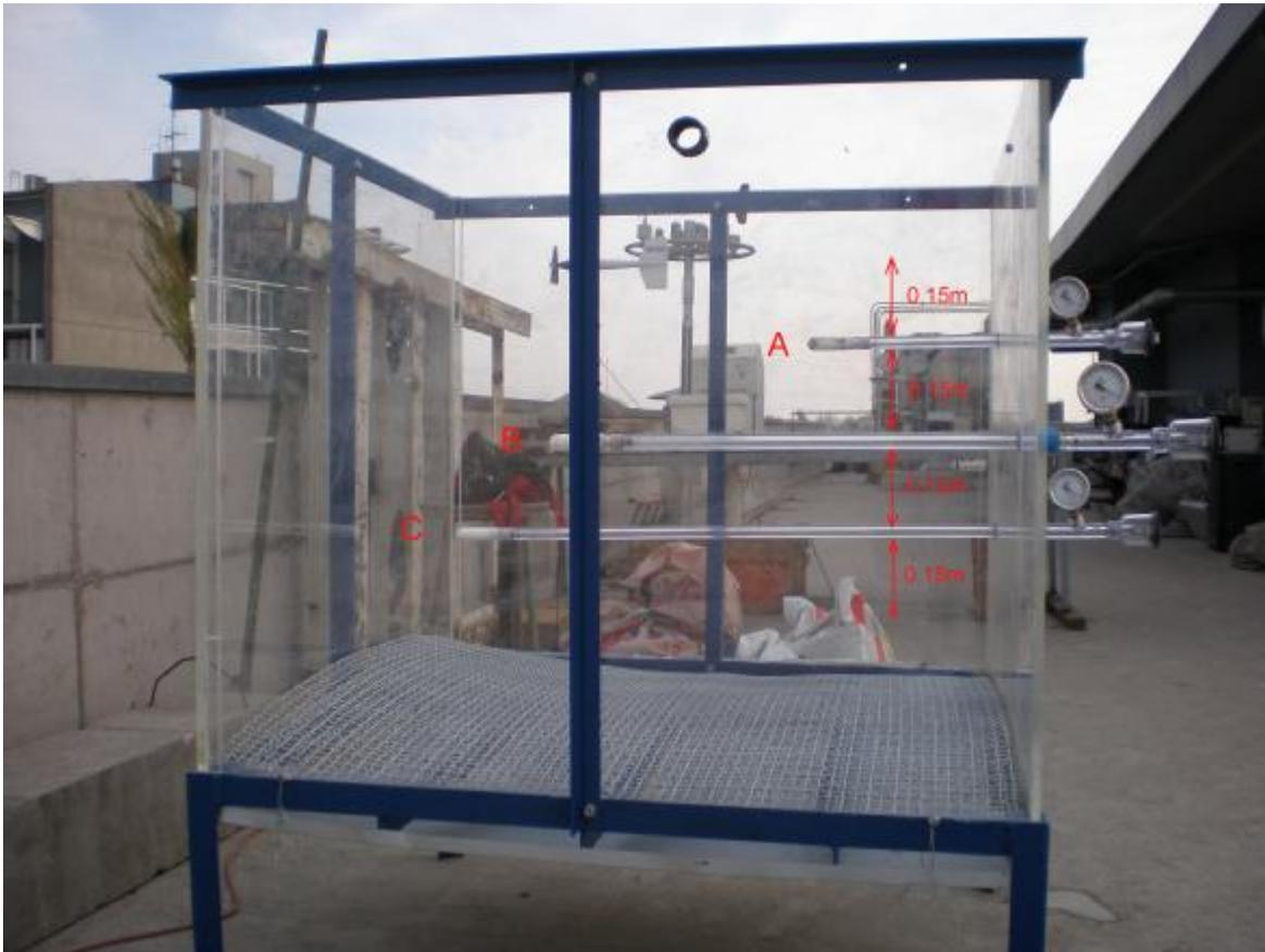
**Figura 2.4: Ubicación de los Tensiómetros**
