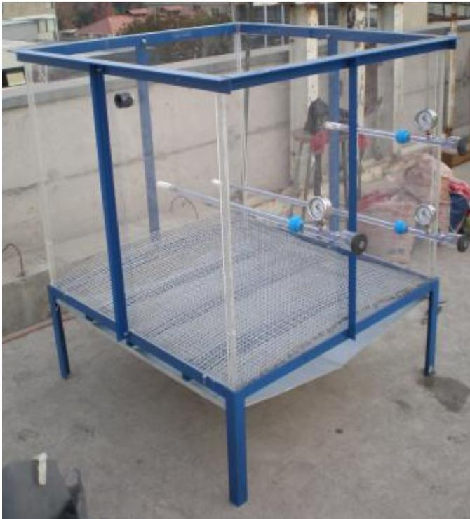
El lisímetro es una estructura con forma cuadrada de lado 1,0m en la superficie y altura de 0,9m (figura 2.3), la cual contiene un suelo característico y permite el flujo libre de la parte superior a la parte inferior.
