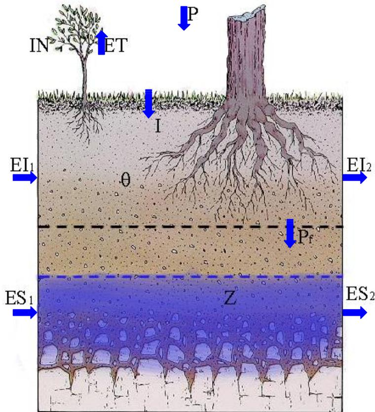
**Fig. 1.2: Esquema del subsistema suelo - agua - planta**
